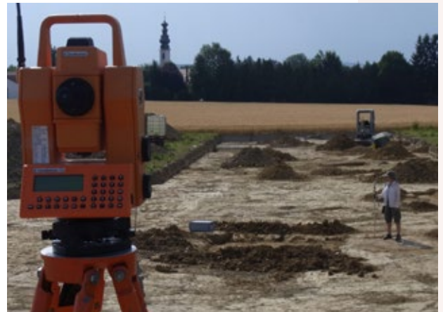
Vermessung einer Grabungsfläche mit der Totalstation Foto: Singulararch
