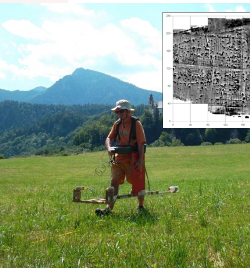
Magnetometer im Einsatz Foto: F. Becker, © BLfD
